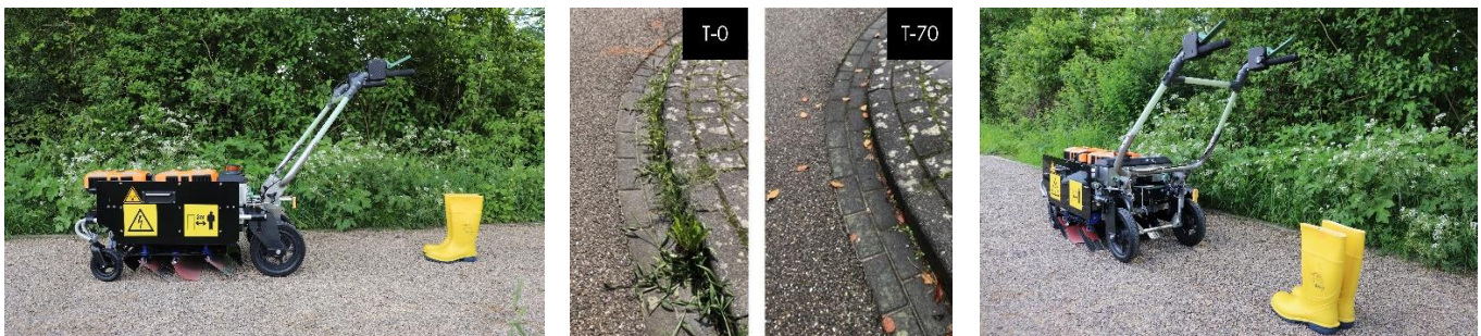
Photos : eWeeding® Roller, powered by Zasso (photos 1 et 3), et efficacité après application (photo 2).
