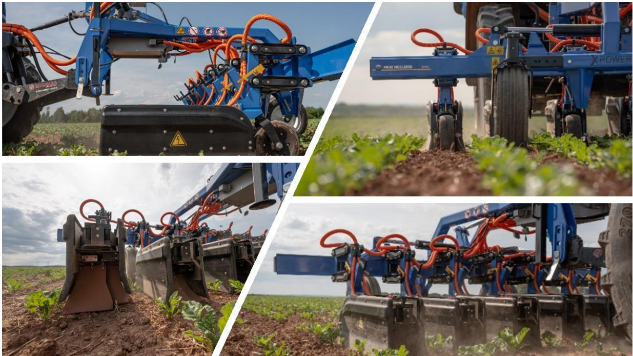
Abb.: XPOWER XPR Konzeptlösung zur elektrischen Unkrautbekämpfung, powered by Zasso, im Einsatz. Fotos: AGXTEND.
